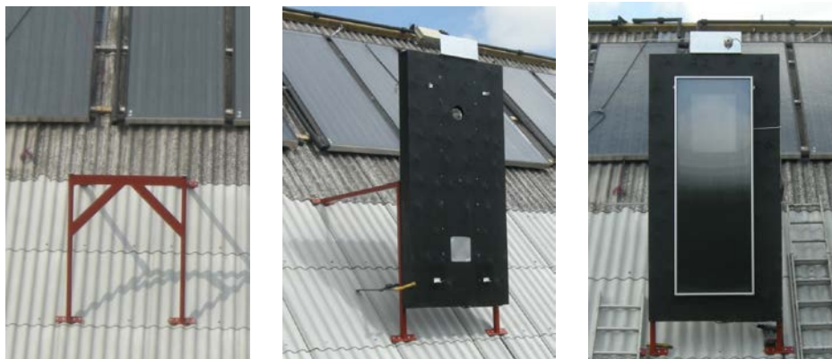
Figur 3. Foto af metalrammen (venstre), hele luftsolfangerprøvestanden (midt) samt prøvestanden med luftsolfangeren SV14 fra SolarVenti A/S og pyranometer monteret (højre).
