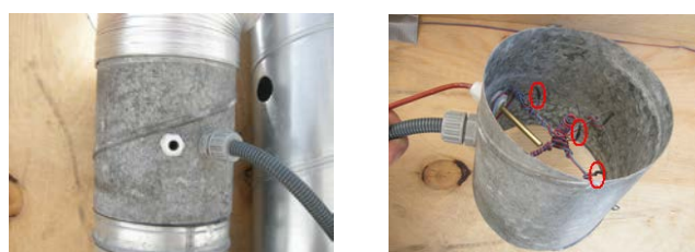
Figur 5. Luftkanal med temperaturfølere. Termoelmenttråd type TT er anvendt til temperaturmålinger. Temperaturføleren PT 100 til højre i figuren anvendes til temperaturkorrektion af volumenstrømmen.
