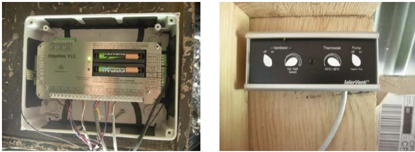
Figur 12. Datalogger type EdgeBox V12 (venstre) og kontrolboksen til luftsolfangeren SV14 fra SolarVenti A/S. Kontrolboksen får strøm fra det indbyggede PV-modul ligesom den i SV14 indbyggede ventilator.
